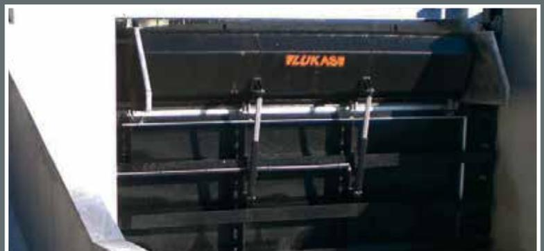
Schütze mit aufgesetzter Klappe
